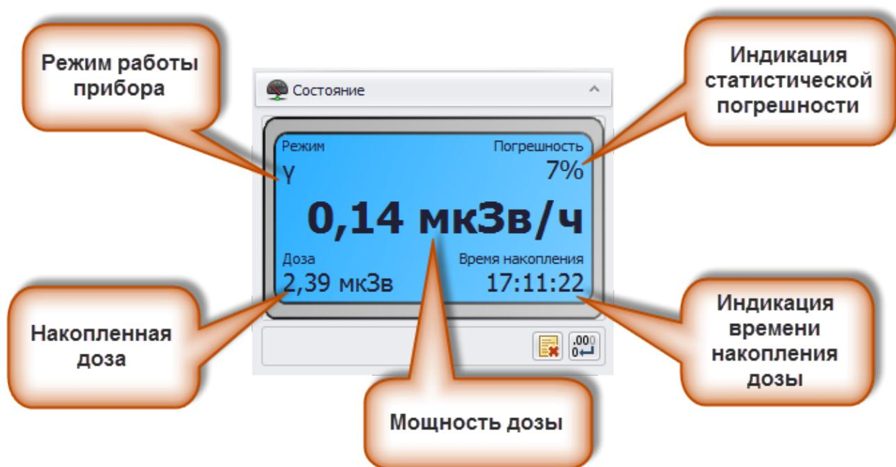
Открывшийся на вкладке экран отображает в режиме реального времени производимые прибором измерения, единицы, в которых производится измерение, статистическую погрешность измерений (в процентах), накопленную дозу, а также время ее накопления.
