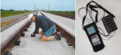
Рис. 9. Рабочий момент контроля качества сцепления шпал с бетоном эхodefектоскопом A1220: справа — дефектоскоп A1220
