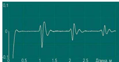
Рис. 11. Осциллограмма эхо-сигналов в свободном анкерном болте
