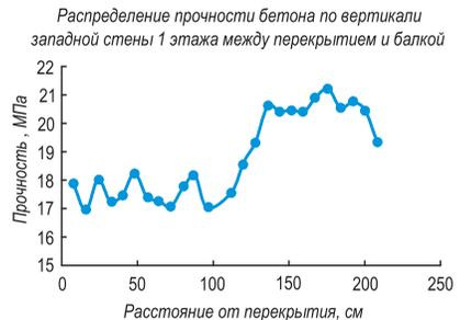
Рис. 3. Распределение прочности бетона по вертикали между перекрытиями
