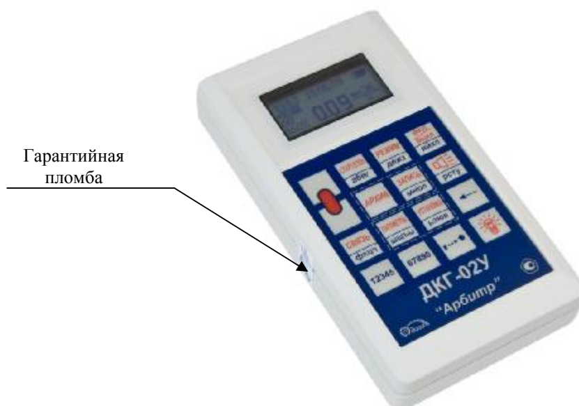
Рисунок 1 – Внешний вид и место опломбирования дозиметра
