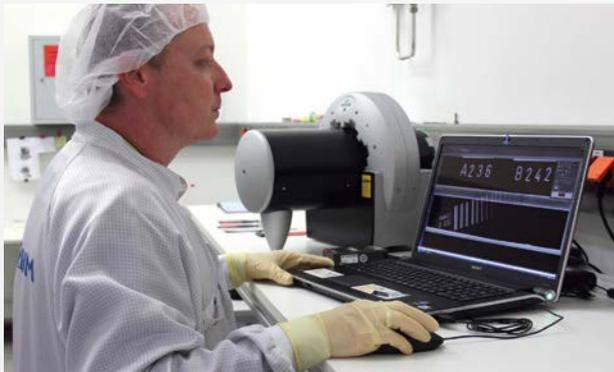
В Airbus DS в Лампольдхаузине технологии Duerr использовались при контроле качества сварных швов силовых установок различных спутников, в том числе Evrostar 3000, Spacebus 4000, а также ATV, модуля питания для МКС. На международном уровне сканеры Duerr HD-CR 35 NDT использовались при контроле сварных соединений для телекоммуникационных спутников Израиля AMOS-4 и AMOS-6, и для спутников Аргентины ArSat-1 и ArSat-2.
