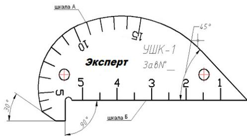
**Шкала Б** предназначена для контроля стыковых сварных соединений и измерения зазора между кромками. Цена деления шкалы Б - 0,5мм. Отклонение положений штрихов от действительных значений - не более  $\pm 0,25$ мм.
