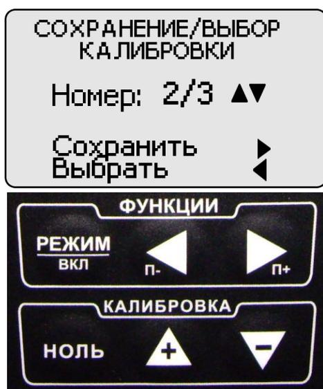
Порядковый номер выбранной градуировочной характеристики (в данном случае 02) и общее число градуировочных характеристик 03 отображаются в центре индикатора. Далее нажать кнопку "◀" (**Выбрать**). После этого прибор войдет в измерительный режим. Измерения будут производиться с выбранной градуировочной характеристикой с номером.
