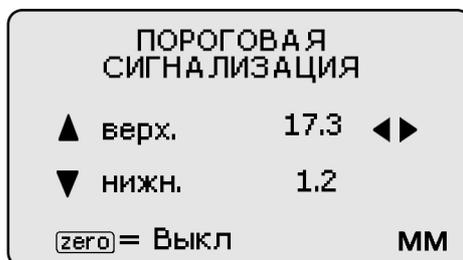
При выключении прибора заданные значения допусков автоматически сохраняются в памяти прибора.
