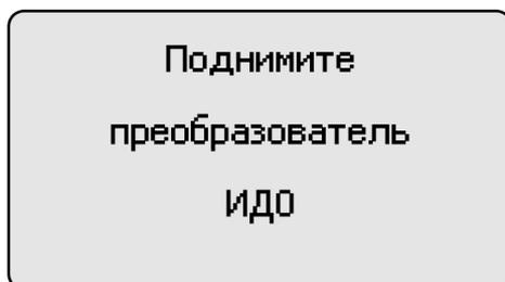
В течение времени индикации сообщения производится тестирование прибора и подключенного преобразователя. В это время следует удерживать преобразователь в воздухе на расстоянии от металлических предметов и объекта измерения, существенно превышающим диапазон его измерения (например, порядка 200 - 300 мм).
