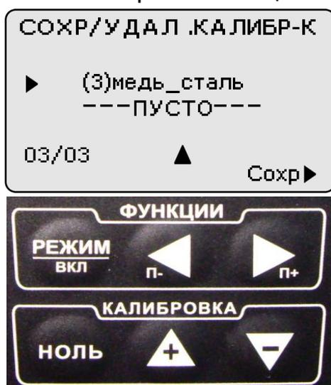
С использованием кнопок "▲" (вперед) и "▼" (назад) сектора "КАЛИБРОВКА" выбрать градуировочную характеристику с параметрами калибровки и номером, которую следует удалить, например,
