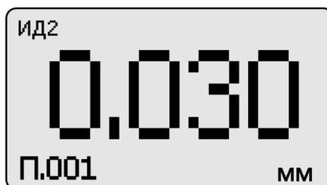
В случае необходимости замены последнего результата, записанного в память (например, ошибочного), после проведения очередного измерения следует нажать кнопку "п-◀" сектора "ФУНКЦИИ", при этом на индикатор в нижней строке будет выдан номер ячейки памяти П.УУУ, в которую записывается результат.
