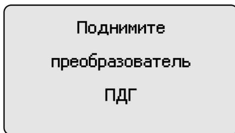
В течение времени индикации сообщения **«ПОДНИМИТЕ ПРЕОБРАЗОВАТЕЛЬ»** производится тестирование прибора и подключенного преобразователя. После появления указанного выше сообщения следует удерживать преобразователь в воздухе на расстоянии от металлических предметов и изделия, существенно превышающим диапазон его измерения (например, порядка 200 мм).
