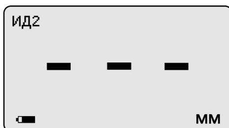
которое свидетельствует о готовности к проведению измерений. В левом верхнем углу выводится сообщение о типе подключенного преобразователя
