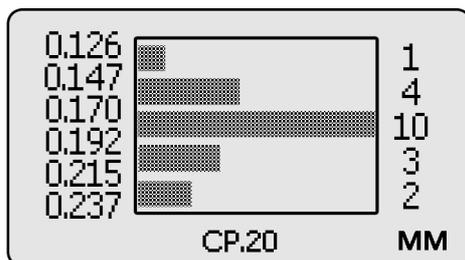
В указанном случае минимальный результат 126 мкм, максимальный результат 237 мкм, интервал ~ 22 мкм, выборка 20 результатов измерения.
