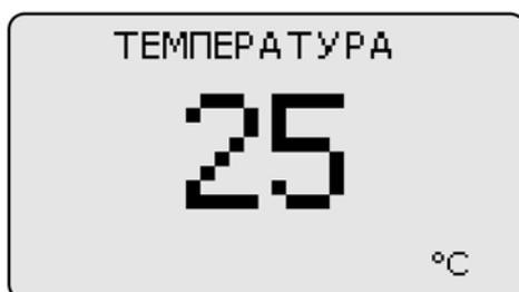
При проведении измерений следует прижать преобразователь контактной поверхностью к поверхности основания (металла) в необходимой зоне и дождаться устойчивых показаний.
