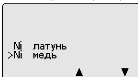
**3.3.4.5** Символом « > » выделена градуировочная характеристика, используемая в настоящее время для проведения измерений. С использованием кнопок «▶» и «◀» сектора «**ФУНКЦИИ**» можно выбрать требуемый режим (должен быть отмечен знаком « > »). Возврат в измерительный режим после выбора необходимой характеристики осуществляется нажатием кнопки «**РЕЖИМ**».
