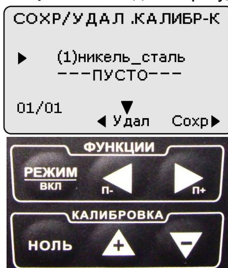
свидетельствующее о том, что градуировочная характеристика с параметрами калибровки сохранена под номером **1** (в данном случае «**(1) цинк сталь**») во встроенной памяти преобразователя. Для возврата в измерительный режим необходимо нажать кнопку **"РЕЖИМ/вкл"**. В дальнейшем для контроля деталей, на которых была выполнена калибровка, необходимо выбрать ее под соответствующим номером. Аналогично можно записать в памяти до девяти градуировочных характеристик с параметрами калибровки и номером.
