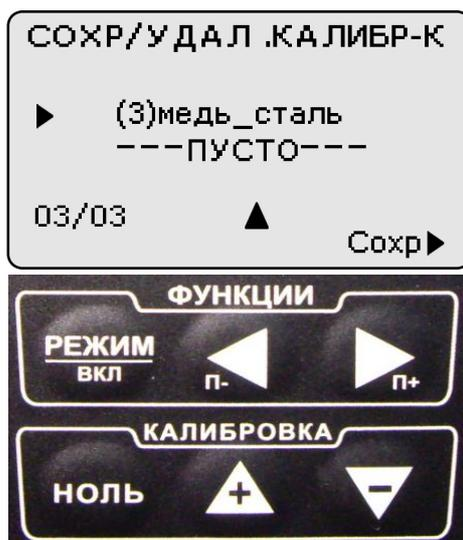
С использованием кнопок **"▲"** (вперед) и **"▼"** (назад) сектора **"КАЛИБРОВКА"** выбрать заменяемую градуировочную характеристику с параметрами калибровки и номером, например
