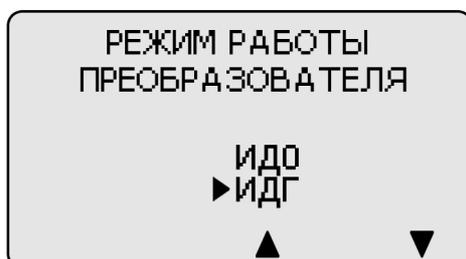
Знаком «▶» отмечен преобразователь, используемый в настоящее время для проведения измерений.
