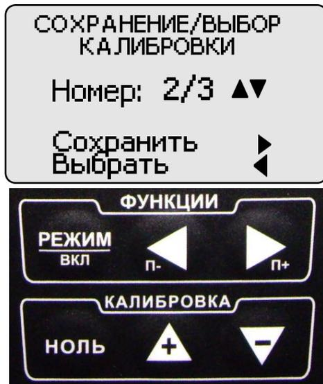
Порядковый номер выбранной градуировочной характеристики (в данном случае 2) и общее число (3) отображаются в центре индикатора. Далее нажать кнопку "**◀**" (**Выбрать**). После этого прибор войдет в измерительный режим. Измерения будут производиться с выбранной градуировочной характеристикой с номером.
