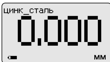
После выполнения описанной выше процедуры провести несколько контрольных измерений толщины образца металлического покрытия на образцовом основании.
