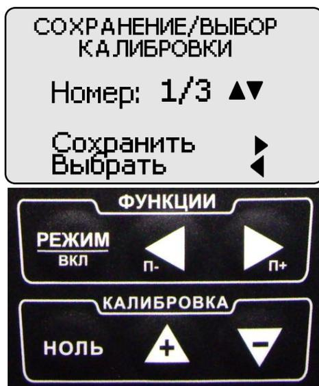
С использованием кнопок "**▲**" (вперед) и "**▼**" (назад) сектора "**КАЛИБРОВКА**" можно выбрать требуемую градуировочную характеристику с номером, с использованием которой необходимо будет производить измерения, например,
