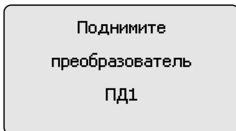
В течение времени индикации сообщения «**ПОДНИМИТЕ ПРЕОБРАЗОВАТЕЛЬ**» производится тестирование прибора и подключенного преобразователя. После появления указанного выше сообщения следует удерживать преобразователь в воздухе на расстоянии от металлических предметов и изделия, существенно превышающим диапазон его измерения (например, порядка 200 мм).
