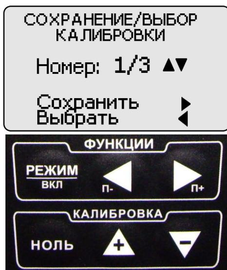
С использованием кнопок **"▲"** (вперед) и **"▼"** (назад) сектора **"КАЛИБРОВКА"** выбрать номер, под которым в памяти преобразователя будет сохранена градуировочная характеристика с параметрами калибровки, например,
