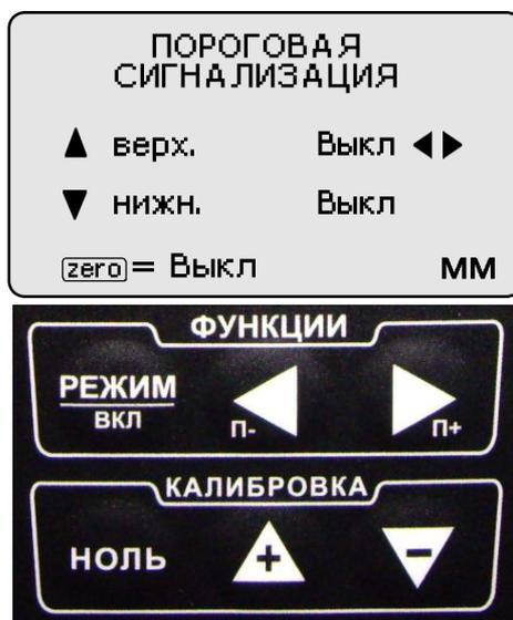
С использованием кнопок **"▲"** и **"▼"** сектора **"КАЛИБРОВКА"** выбирается задаваемый допуск (**ВЕРХ** – верхний, **НИЖН** – нижний). В строку выбранного допуска переместятся символы **«◀»** и **«▶»**. Далее с использованием кнопок **«◀»** (уменьшение) и **«▶»** (увеличение) сектора **"ФУНКЦИИ"** задать величину выбранного допуска, например:
