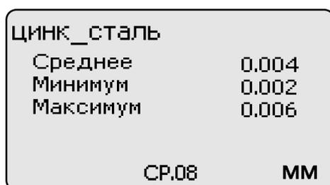
Для удержания данного сообщения на экране следует вновь нажать и удерживать кнопку "**СТАТ**". При ее отпускании прибор перейдет в измерительный режим.
