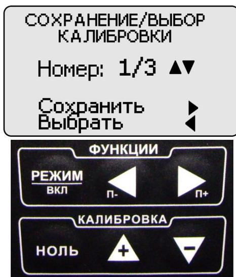
С использованием кнопок "▲" (вперед) и "▼" (назад) сектора "КАЛИБРОВКА" можно выбрать требуемую градуировочную характеристику с номером, с использованием которой необходимо будет производить измерения, например,
