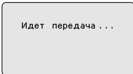
8. На мониторе компьютера в окне «ПРИЕМ ДАННЫХ» отображается процесс передачи. По окончании приема данных на мониторе компьютера выведется окно с таблицей принятых данных, а на индикаторе прибора сообщение
