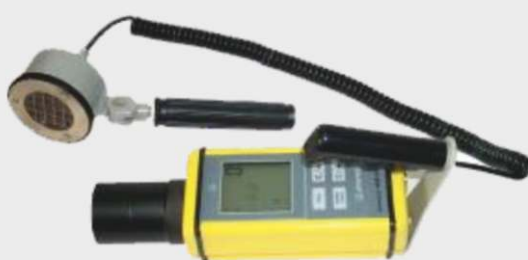
Подключение внешнего блока детектирования БДПС-02
