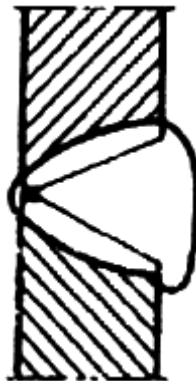
Рисунок ПА-46 - Наплыв (натек) в сварном соединении
