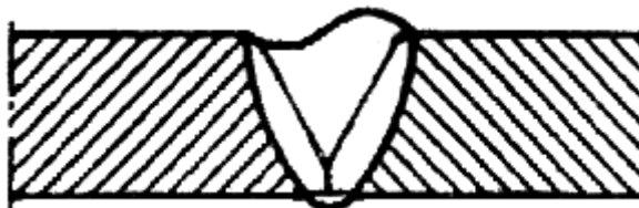
Рисунок ПА-49 - Неполностью заполненная разделка кромок
