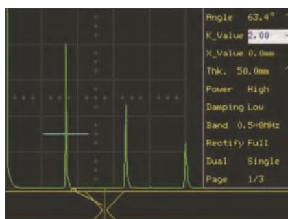
Функция профиля сварного шва
