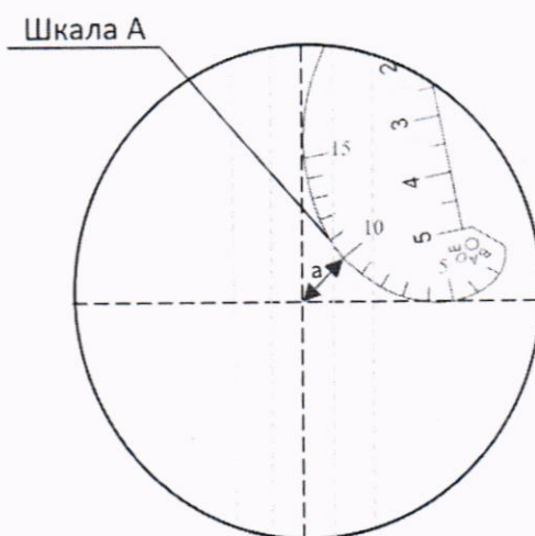
Рисунок 5 – Поле зрения визирной системы микроскопа при первоначальном расположении шаблона на предметном столе микроскопа
