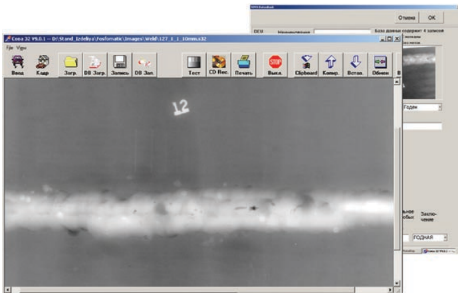
Рис. 1. Типовое рентгеновское изображение, получаемое с применением комплекса «Фосфоматик» и программного обеспечения «СОБА»
