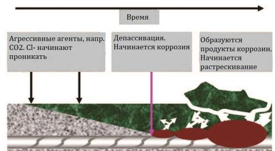
Покрытие бетона может быть оценено, при помощи проверки глубины насыщения углекислотой, содержание хлоридов, единство поверхностей, удельное сопротивление и проходимость. Условие укрепления оценивается при помощи измерения глубины покрытия, толщины арматуры, и с использованием метода потенциала полуэлементов.
