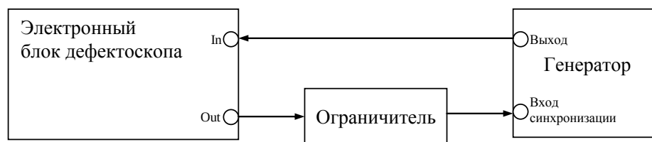
Рисунок 5 - Схема определения временных характеристик приемного тракта дефектоскопа
