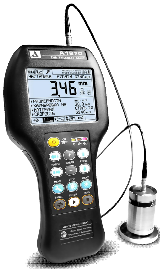
Рисунок 1 – Толщиномер электромагнитно-акустический А1270
