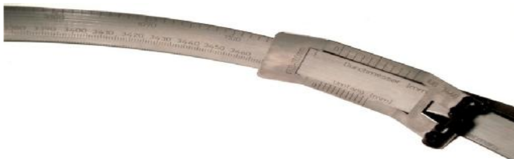
Рисунок 2 – Циркометр для измерения внутренних диаметров и длин окружностей IUB
