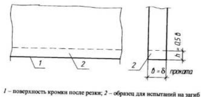
Рисунок Б9.2 - Порядок изготовления образца для испытания кромки на пластичность
