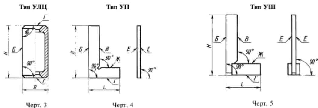
$B, B$  — измерительные поверхности угольников;  $F, Ж$  — опорные поверхности;  $E$  — боковые поверхности
