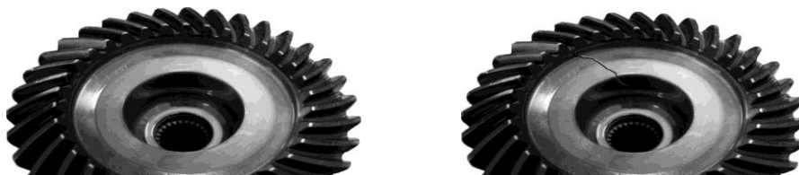
Рис. 2. Внешний вид шестерни редуктора вертолета с усталостной трещиной до и после проведения магнитопорошкового контроля при помощи дефектоскопа МД–М
