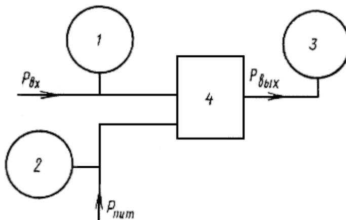
1 - образцовый прибор для задания (измерения) входного давления; 2 - прибор для контроля давления воздуха питания; 3 - образцовый прибор для измерения (задания) выходного сигнала;
