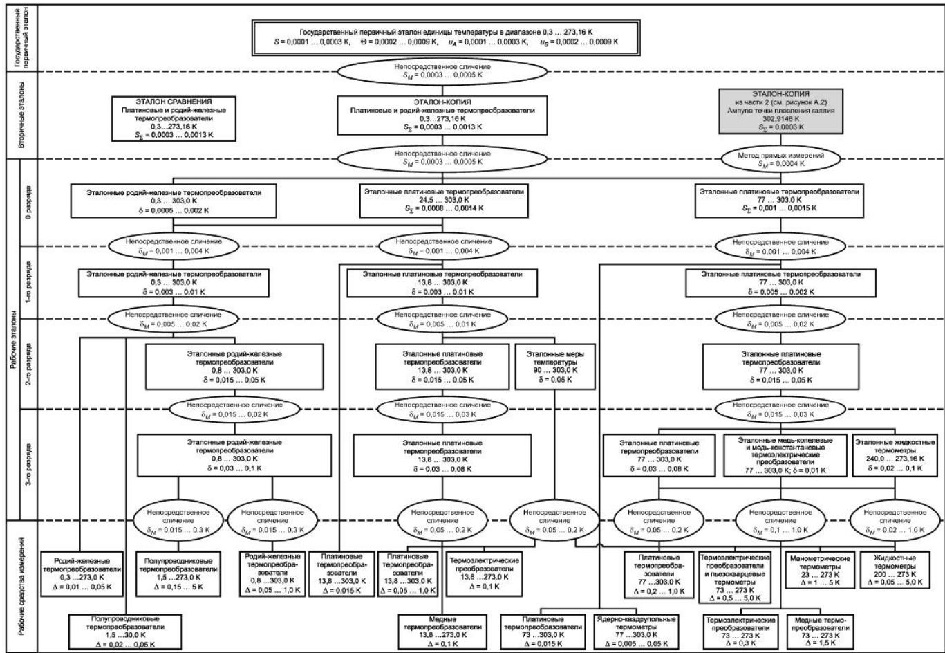
Рисунок А. 1 - Проверочная схема для контактных термометров в диапазоне 0,3 К ... 273,16 К
