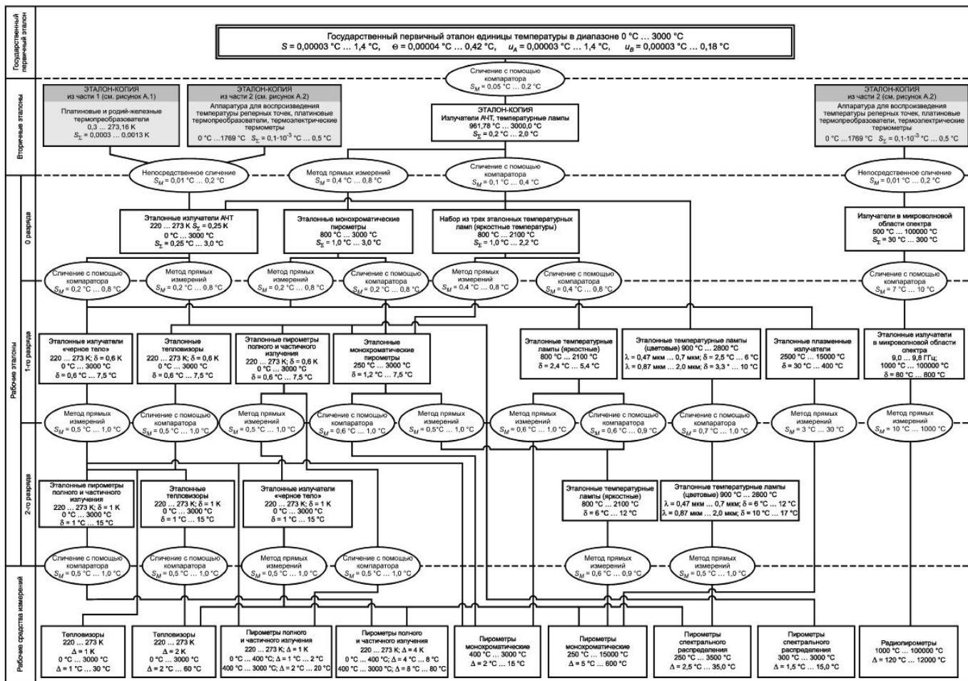
Рисунок А.3 - Проверочная схема для радиационных термометров
