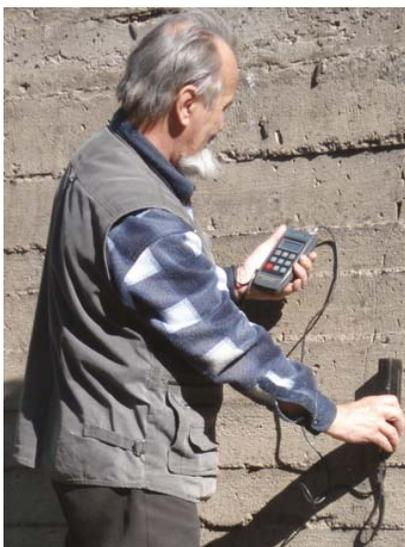
Рис. 5. Контроль положения арматуры и толщины защитного слоя бетона прибором «Поиск-2.3»
