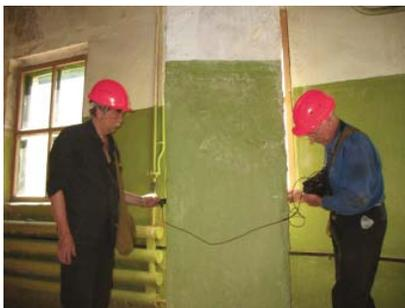
Рис. 1. УЗК железобетонной колонны промышленного здания
