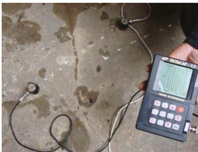
Рис. 4. Контроль глубины трещины в бетоне методом поверхностного ультразвукового прозвучивания
