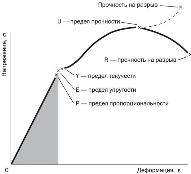
Рис. 1. Кривая напряжение-деформация
