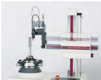
Измерение в процессе слежения по оси X
