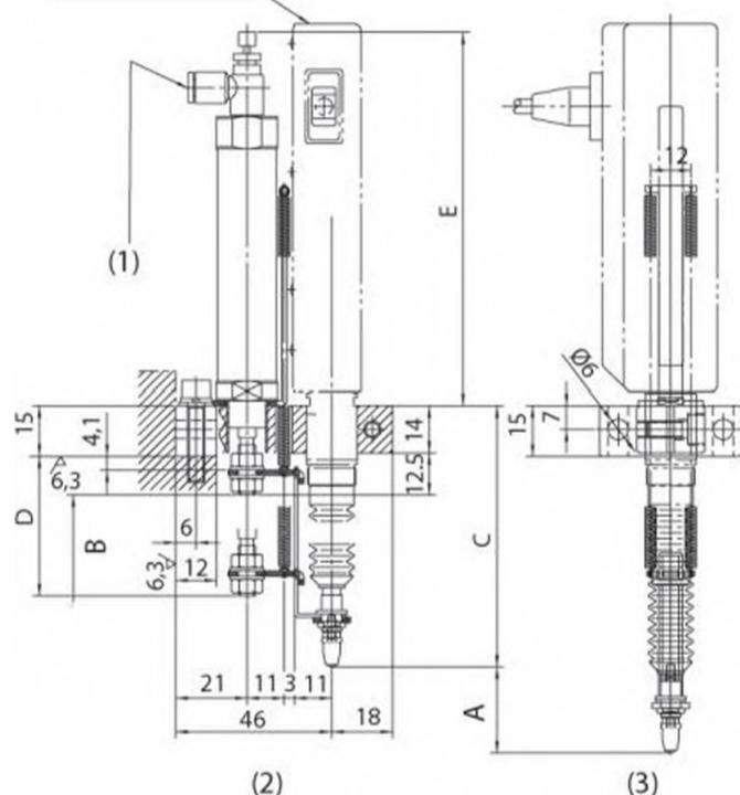
Для линейных датчиков с диапазоном 25 мм и 50 мм
