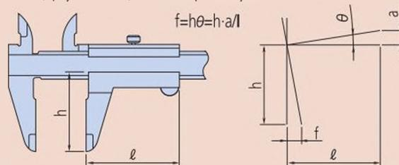
Пример: Допустим, что отклонение губок из-за нажима ползунка составляет 0.01 мм в 50 мм, а губки для внешних измерений находятся на глубине 40 мм, тогда погрешность (на концах губок) составит  $(40/50) \times 0.01 \text{ мм} = 0.008 \text{ мм}$ . Если ведущая сторона изношена, тогда погрешность может происходить даже при приложении правильного измерительного усилия.
