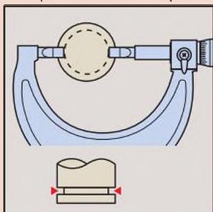
Для измерения диаметра узких внутренних канавок
