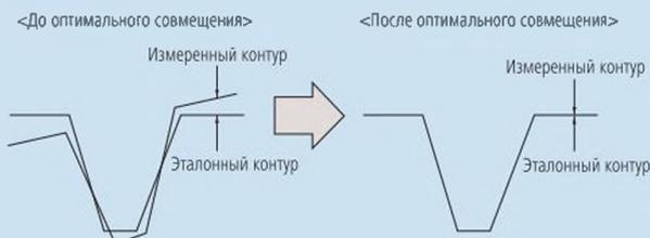
Алгоритм по оптимальному совмещению данных направлен на поиск отклонений между обоими комплектами данных, он создаёт систему координат, в которой сумма квадратов отклонений минимальна при наложении полученных при измерении данных на эталонные.
