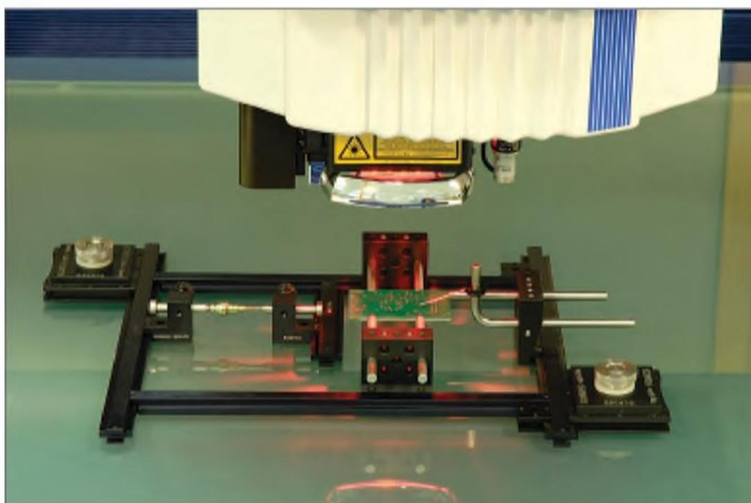
Электронная плата поднята для доступа к компонентам на ее нижней стороне. Размещение прямо на стеклянной платформе машины без OPTI-FIX, электронная плата не будет лежать ровно. Установка производится на поверхности стекла с помощью 2 присосок.
