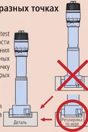
При использовании конца пятки для измерения, перенастройте точку отсчёта соответствующим образом.
