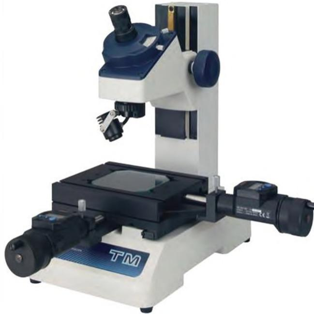
Микроскоп TM-505B снабжается опциональными цифровыми микрометрическими головками
