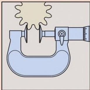
Для измерения длины общей нормали на прямозубых и косозубых цилиндрических шестернях.
