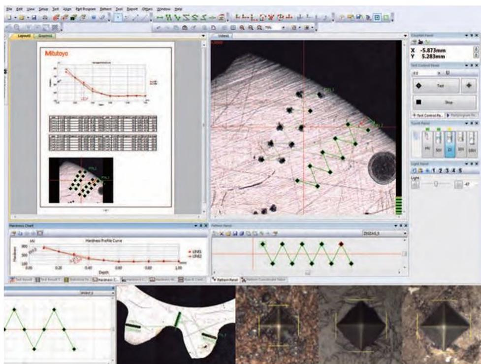
Интерфейс экрана управления, измерения и отображения результатов можно свободно изменять.
