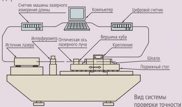
Точность шкалы в каждой точке определяется в виде величины погрешности, которая рассчитывается по следующей формуле:
