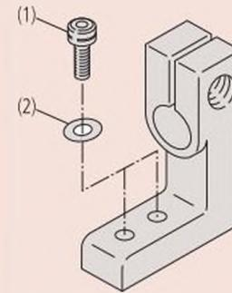
Зажимные приспособления цапгового типа для микрометров со стандартным микровинтом, зажим производится затяжкой винта (M3x0,5x12 мм).
