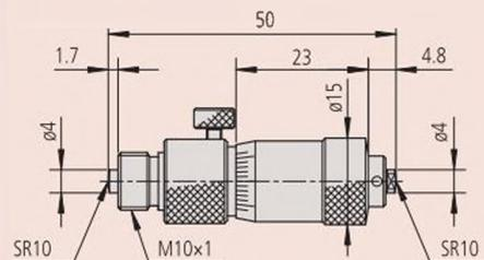
Микрометрическая головка для серии 137
