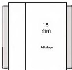
Защитные КМД (выделены серым цветом) устанавливаются с обеих сторон КМД, чтобы защитить от износа, вызванного контактом с деталью.
