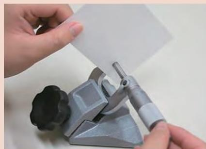
5. Ежедневно стирайте пыль, стружку и другие загрязнения с периферийной и измерительной поверхностями микрометрического винта (шпинделя). Кроме того, необходимо стирать сухой тканью пятна и отпечатки пальцев со всех частей инструмента.
