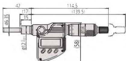
350-281-10 Ø с отведённым микрометрическим винтом
