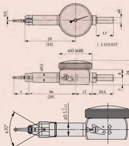
Для пылезащитных моделей 513-517WE/T измерительный рычаг должен располагаться в диапазоне ±30° к детали (см. рисунок).
