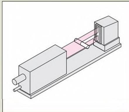
Измерение внешнего диаметра и
