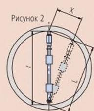
l: Внутренний измеряемый диаметр
