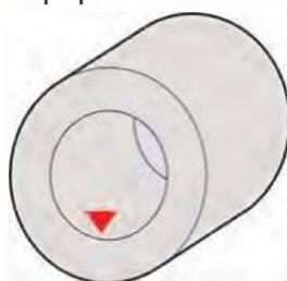
Можно испытывать образцы различных форм. Механизм индентора типа "нос дельфина" позволяет проводить внутренние измерения образцов труб, а также верхней поверхности плоского образца.
