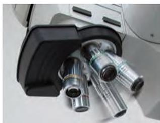
Опциональная моторизованная револьверная головка для 5 объективов
