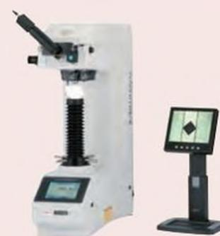
Тип с ручным управлением с видеосистемой 810-454D
