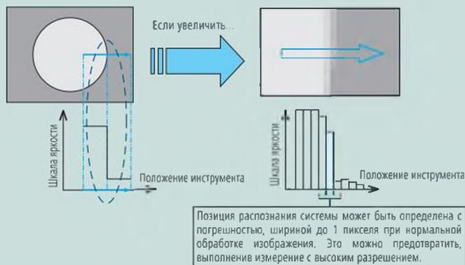
Для повышения точности при определении границ используется субпиксельная обработка изображений. Границы определяются путем установления кривой интерполяции от смежных данных элемента изображения, как показано ниже. В результате это позволяет сделать измерение с разрешением более 1 пикселя.
