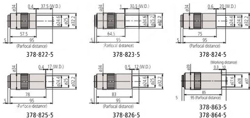
**M Plan Apo NIR с коррекцией ближней инфракрасной области спектра для наблюдения в светлом поле**
