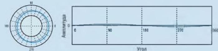
Условие в 2 ед/об может означать: (1) недостаточное выравнивание измерительного устройства; (2) Круговой эксцентриситет ввиду неверной установки рабочей детали на обрабатывающем станке; (3) эллиптическую форму рабочей детали по конструкции как, например, поршень в двигателе внутреннего сгорания.
