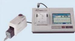
Приборы для измерения контура
