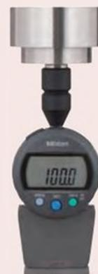
Пример применения грузов с дюрометром
