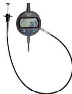
Кабель подъёма стержня 500 мм
