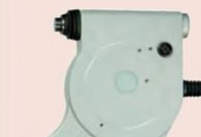
Регулировочный винт для компаратора ± 5 мкм
