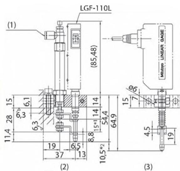
Для линейных датчиков с диапазоном 10 мм
