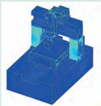
Используя метод анализа FEM (Finite Element Method) конструкции основания, определяются расположение ребер жесткости и лучей для Ultra Quick Vision для обеспечения оптимальной жесткости.
