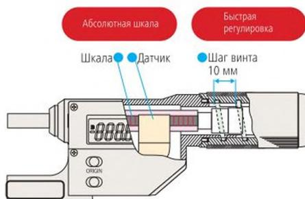
Конструкция этого микрометра обеспечивает подачу микрометрического винта 10 мм/об. Таким образом, подача осуществляется в 20 раз быстрее, чем у обычных микрометров.
