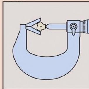
Для измерений 3- или 5-канавочных режущих
