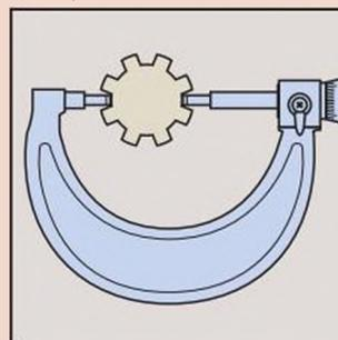
Для измерения диаметра шлицевых валов
