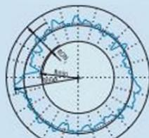
$$RON_L = R_{max} - R_{min}$$
