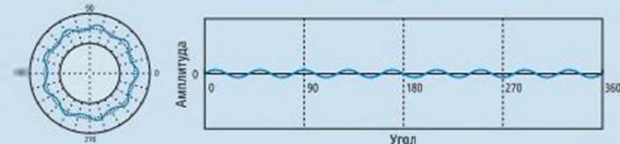
Условие 15 (или более) ед/об обычно вызвано болтанием инструмента, вибрацией машины, эффектом подачи охлаждающей жидкости, неоднородностью материала и т.д., и как правило более важно для функциональности, чем подходящей детали.
