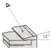
Легкое считывание благодаря наклону нониусной шкалы на 14 градусов
