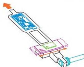
Даже при измерениях с двухметровым удлинителем точность остаётся прежней, так как передача данных производится электроникой.
