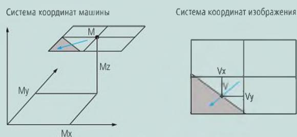
Положение стола измерительного устройства
