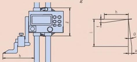
Установка метчика (или индикатора рычажного типа) требует аккуратности, так как это влияет на размер погрешности, возникающей при искривлении базовой колонны с увеличением значения  $h$  в вышеуказанной формуле. Другими словами, при использовании дополнительного длинного метчика или рычажного циферблатного индикатора, погрешность увеличивается.
