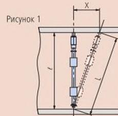
l: Внутренний измеряемый диаметр
