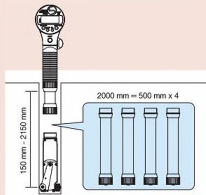
Четыре удлинительных стержня (500 мм каждый), соединённые вместе, дают 2 м длины.
