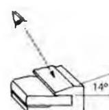
Лёгкое считывание благодаря наклону нониусной шкалы на 14 градусов
