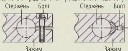
Рекомендованный диаметр отверстия крепления: 15 мм +0.034/-0.014
