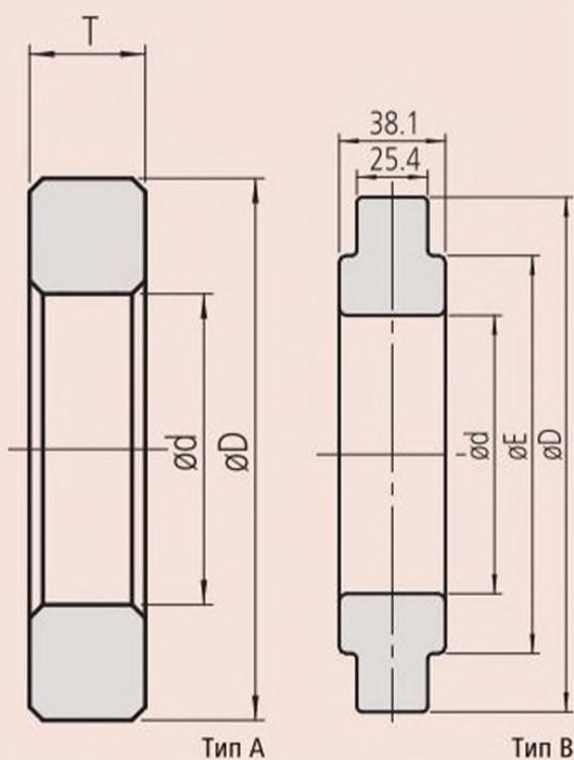
Допустимое отклонение от номинального диаметра  $\pm 0,01$  мм до 45 мм и  $\pm 0,02$  мм - свыше.
