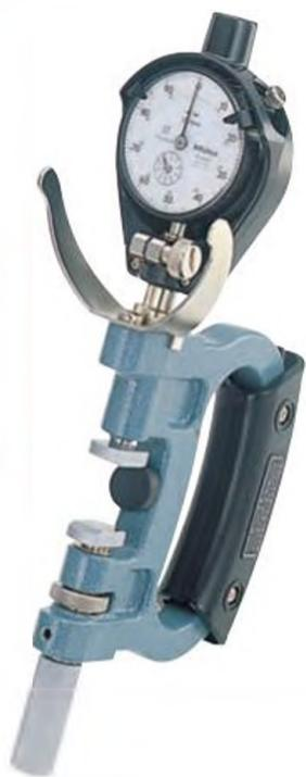
201-101 с дополнительным индикатором часового типа
