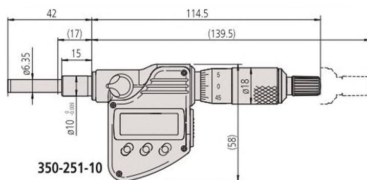
( ): с полностью отведённым микрометрическим винтом
