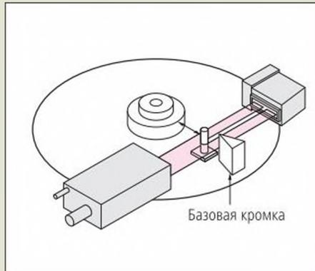
Измерение наружного диаметра
