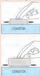
**Заметка:** Абразивная поверхность Ceraston должна быть плоской посредством полировки время от времени. После полировки Ceraston, порошок должен быть полностью удален с поверхности камня, чтобы предотвратить царапины на КМД. Митутойо не предлагает Арканзасские камни.
