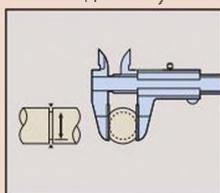
Для измерения диаметра узких канавок
