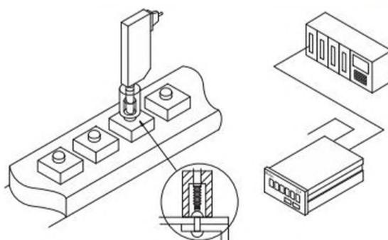
Устройство для проверки головок заклепок
