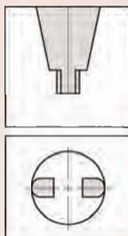
Скругленные поверхности губок для измерения внутренних размеров
