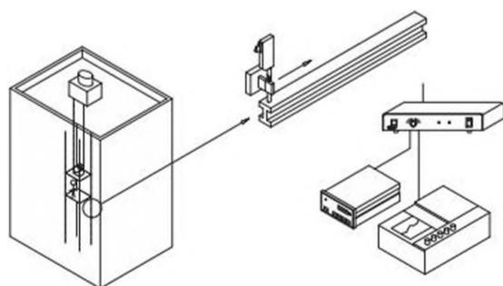
Измерение отклонения подъемных балочных направляющих
