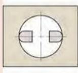
Скруглённые измерительные поверхности для измерения внутренних размеров
