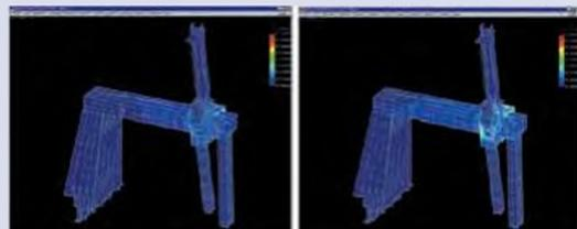
Конструкция машины оптимизирована при помощи метода конечных элементов и анализа методом нормальных волн
