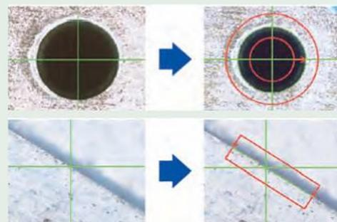
Обнаружение кромки одним нажатием. Просто щелкнув мышью на кромку детали, QSPAK автоматически сканирует кромку, обнаруживает и показывая ее координаты. Эта функция работает также инструментами точка, прямоугольник, окружность и автофокусом.
