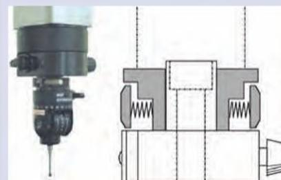
Эргономический дизайн ведущего захвата на оси Z для надежного измерения (только для Crysta-Plus M776 и M7106)
