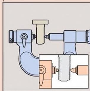
Для эффективного измерения винтовой резьбы
