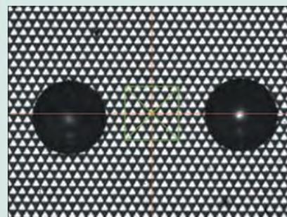
Автофокус : фокусировка по шаблону (используется для сложных поверхностей, как зеркала, полированная поверхность прозрачного стекла).
