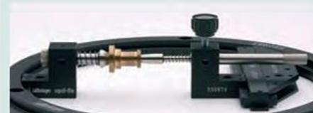
Удерживает цилиндрическую деталь между крепежными наконечниками.
