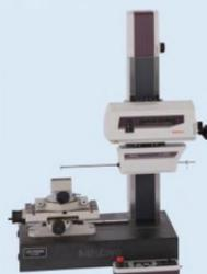
Приборы для измерения шероховатости и контура
