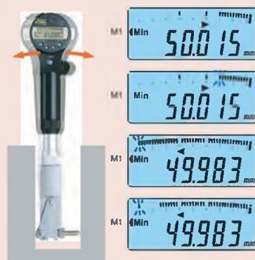
Индикаторный нутромер ABSOLUTE Digimatic определяет минимальное значение (истинный диаметр) и автоматически сохраняет его.
