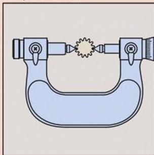
Для измерения размера по роликам зубчатых колёс
