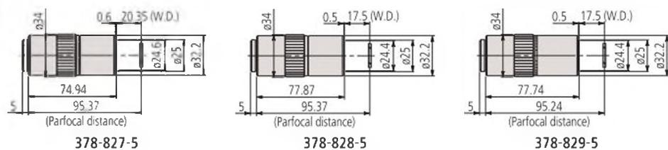
**LCD Plan Apo NIR с коррекцией ближней инфракрасной области спектра и толщины стекла ЖК-монитора для наблюдения в светлом поле**
