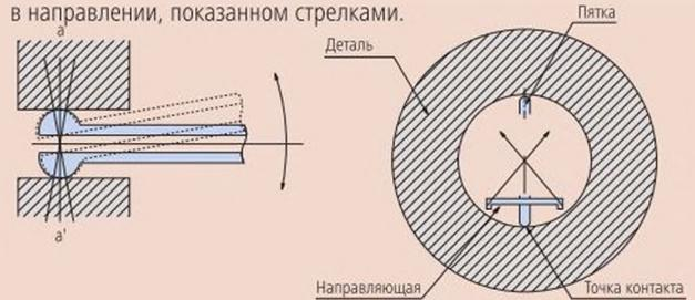
● Направляющая пластина с пружинным механизмом двухточечного нутромера Митутойо автоматически обеспечивает радиальную соосность, поэтому для определения истинного диаметра достаточно раскачивания инструмента в осевом направлении (считывается минимальное значение).
