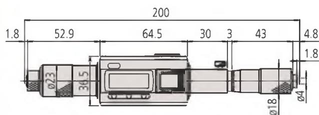
Микрометрическая головка для серии 337
