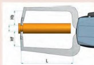
Измерительные наконечники: твердосплавный шарик  $\varnothing 1,5$  мм
