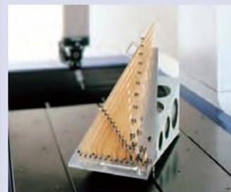
Калибровка КИМ с использованием стеклянного калибра с коэффициентом термального расширения, фактически, равным нулю
