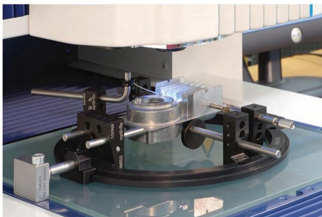
Пример применения с призматическими держателями (без системы зажима OPTI-FIX деталь нельзя корректно спозиционировать). Установка производится на стеклянной поверхности посредством магнитного зажима, прикрепленного к раме.
