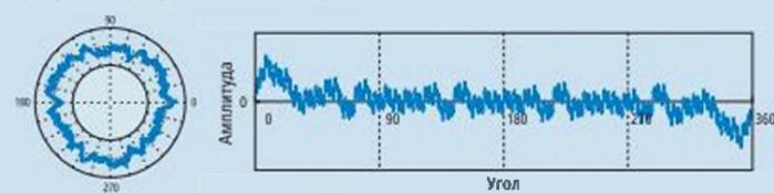
Условие в 1 ед/об указывает на эксцентриситет рабочей детали относительно оси вращения измерительного устройства. Амплитуда компонента волнообразных колебаний зависит от настройки выравнивания.
