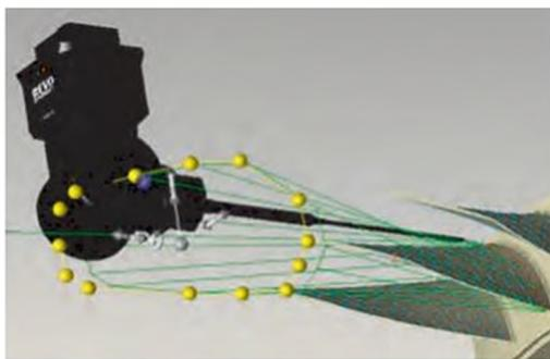
Установка сечений на CAD-модели
