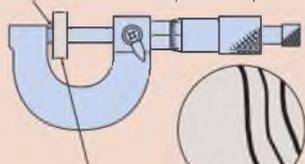
Оптическая плоскопараллельная пластина
