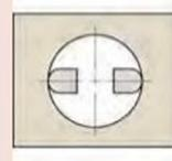
Скруглённые измерительные поверхности для измерения внутренних размеров
