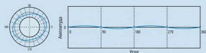
Условие от 3 до 5 ед/об может означать: (1) Деформацию ввиду чрезмерной затяжки зажимного патрона на измерительном устройстве; (2) Деформацию ввиду сниженного внутреннего напряжения после снятия детали с зажимного патрона на обрабатывающем станке.
