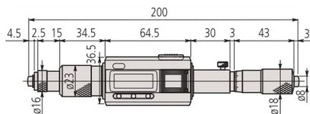
Микрометрическая головка для серии 339
