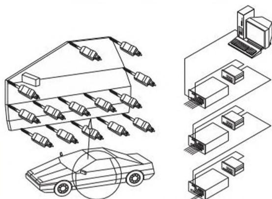
Многоточечные измерения на дверях автомобилей
