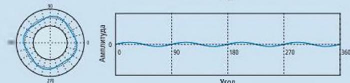
Условие от 5 до 15 ед/об часто означает дисбаланс факторов методики механической обработки или процессов производства детали.
