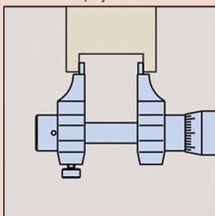
Для измерения малых внутренних диаметров и ширины канавок
