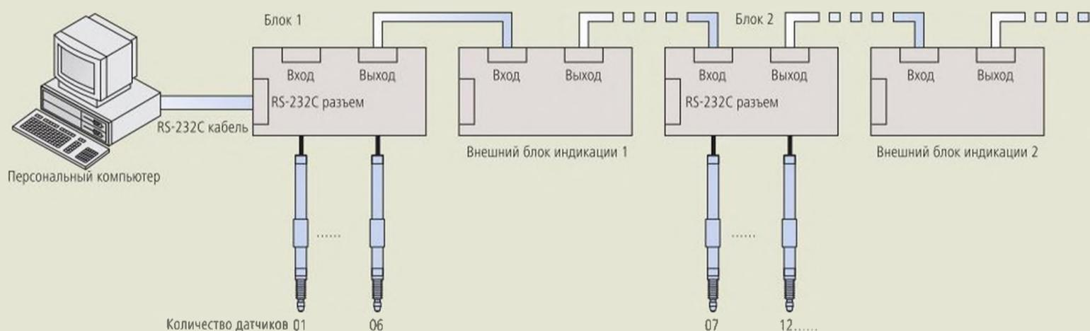
Комплект измерительного блока и блока индикации
