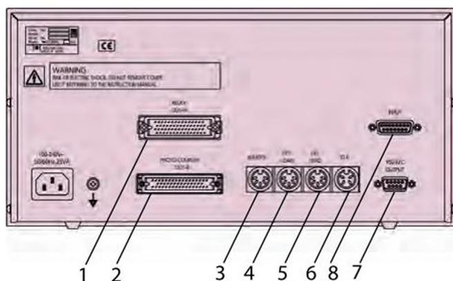
1. Выходной сигнал реле
