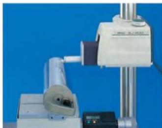
Измерение радиусной поверхности
