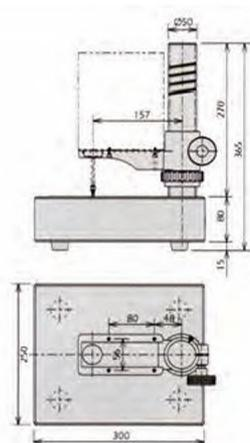
957460 Компаратор (стенд)
