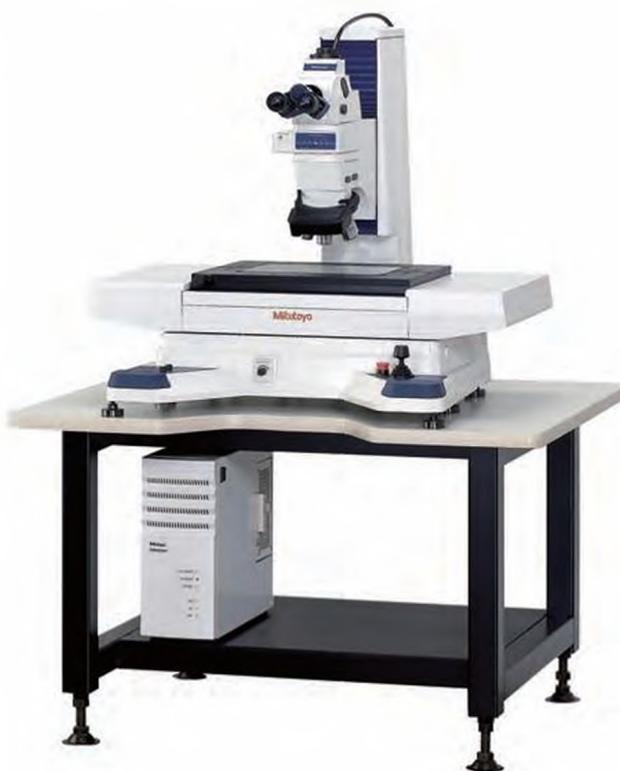
Hyper MF-UF2515B с опциональными револьверной головкой и объективами
