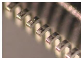
Пример измерения : высота пиков на QFP-корпусе
