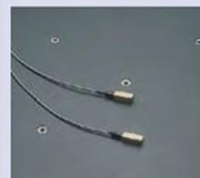
Система термокомпенсации (температурные датчики)
