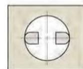
Скруглённые измерительные поверхности для измерения внутренних размеров
