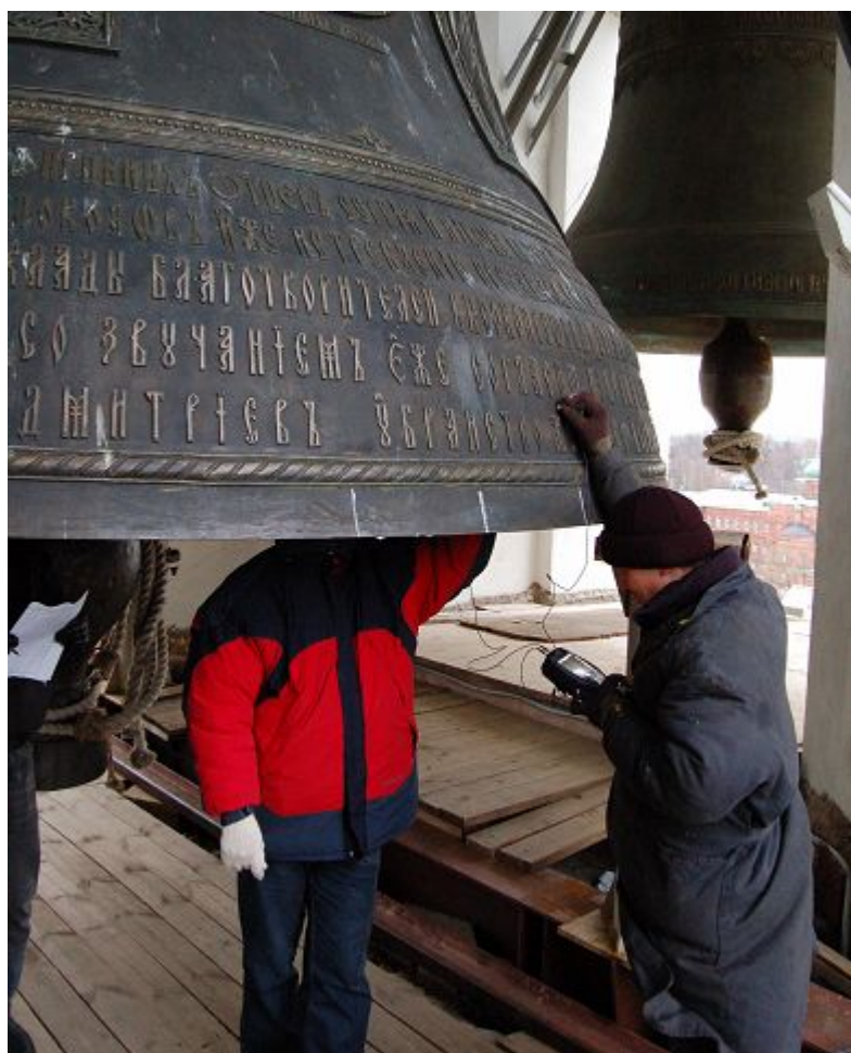
Рис. 10. Позиционирование ПЭП для получения максимального сигнала.
