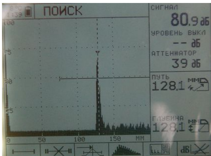
Рис. 11. Измерение амплитуды сигнала А, пути Н.
