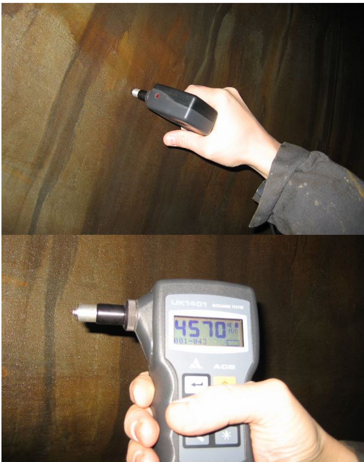
Фото 1 Измерение скорости распространения УЗК.
