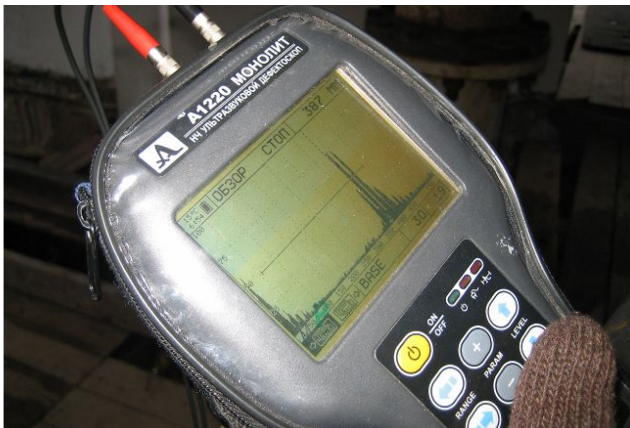
Фото 3. Проведение измерений амплитуды эхо-сигнала Адб, измерение толщины стенки колокола Н, мм.
