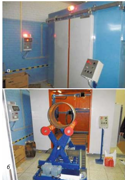
Рис. 6. Рентген-телевизионная кабина: а — заготовка укладывается на механизированную тележку и заезжает в кабину; б — двери кабины закрываются, о чем свидетельствует включение красных ламп
