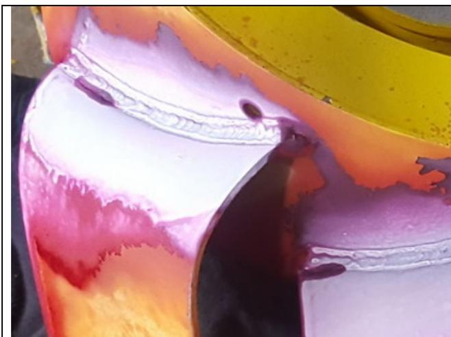
Рабочее колесо с дефектами в зоне сварного шва.
