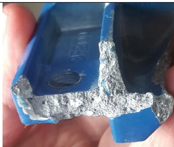
Характер изломов опор двигателя
