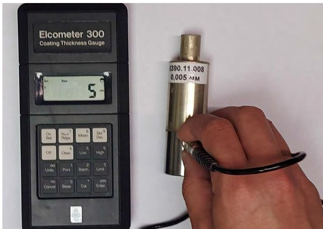
Калибровка по образцу гальванического покрытия
