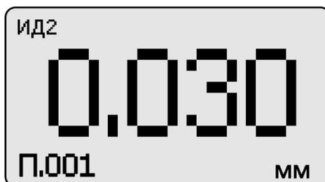
В случае необходимости замены последнего результата, записанного в память (например, ошибочного), после проведения очередного измерения следует нажать кнопку "п-◀" сектора "ФУНКЦИИ", при этом на индикатор в нижней строке будет выдан номер ячейки памяти П.УУУ, в которую записывается результат.
