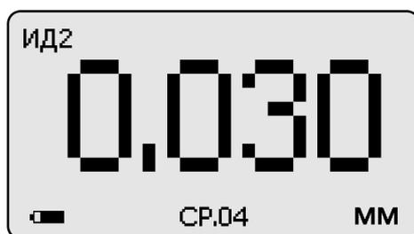
**3.2.5.3** По окончании процедуры измерения с усреднением (после достижения последней точки по зоне контроля или при начале контроля следующей детали) необходимо нажать кнопку "СБРОС" на секторе "СРЕДНЕЕ" клавиатуры, при этом цикл измерения с усреднением будет закончен, а на индикаторе останется последний результат измерения.
