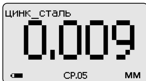
**3.4.3.3** По окончании процедуры измерения с усреднением (после достижения последней точки по зоне контроля или при начале контроля следующей детали) необходимо нажать кнопку **"СБРОС"** на секторе **"СРЕДНЕЕ"** клавиатуры, при этом цикл измерения с усреднением будет закончен, а на индикаторе останется последний результат измерения.
