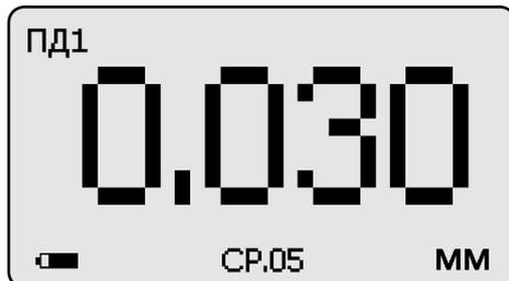
**3.3.5.3** По окончании процедуры измерения с усреднением (после достижения последней точки по зоне контроля или при начале контроля следующей детали) необходимо нажать кнопку "**СБРОС**" на секторе "**СРЕДНЕЕ**" клавиатуры, при этом цикл измерения с усреднением будет закончен, а на индикаторе останется последний результат измерения.
