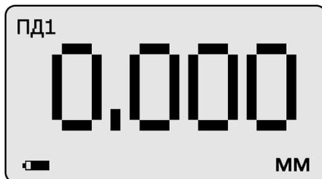
После выполнения описанной выше процедуры провести несколько контрольных измерений мер толщины из комплекта КОП в диапазоне контролируемых толщин **hмакс** на образце детали или конструкции.
