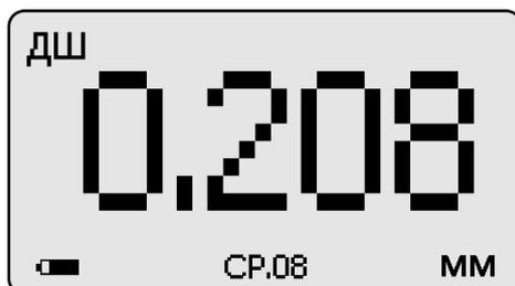
**3.5.3.3** По окончании процедуры измерения с усреднением (после достижения последней точки по зоне контроля или при начале контроля следующей детали) необходимо нажать кнопку **"СБРОС"** на секторе **"СРЕДНЕЕ"** клавиатуры, при этом цикл измерения с усреднением будет закончен, а на индикаторе останется последний результат измерения.
