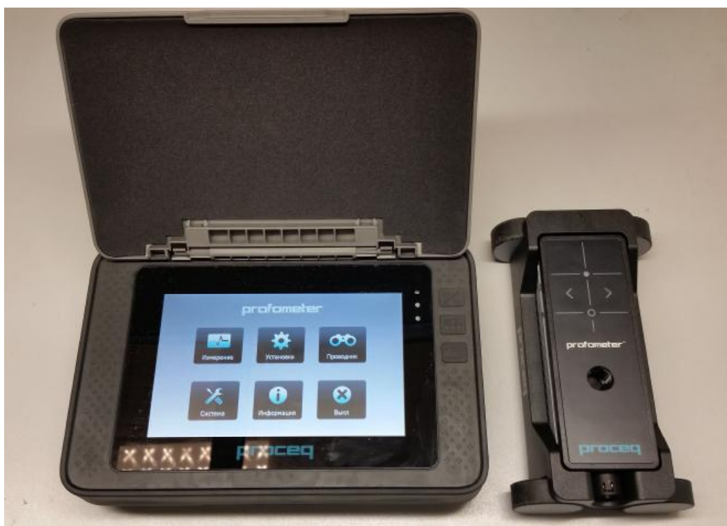
Рисунок 1 - Внешний вид прибора для измерения толщины защитного слоя бетона Profoscope
