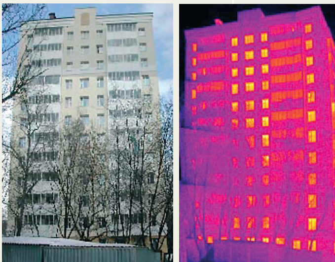
Рис. 6. Санация старого жилого фонда: а – до реконструкции, R_{np} = 1,0 \text{ м}^2 \text{ град/Вт} ; б – после реконструкции, R_{np} = 3,0 \text{ м}^2 \text{ град/Вт}
