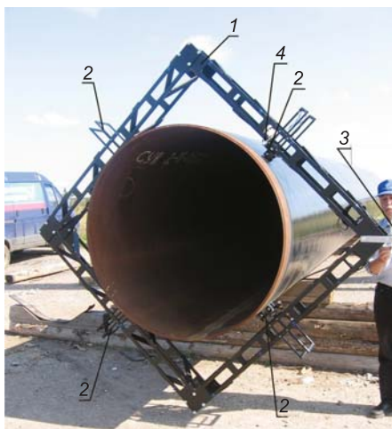
Рис. 4. Внешний вид толщиномера МТП-10Т
