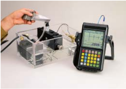
Рис. 1. Процесс измерения толщиномером 25 DL PLUS
