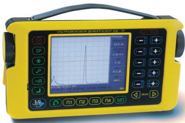
Рис. 1. Внешний вид модернизированного дефектоскопа УД2-70
