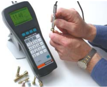
Рис. 2. Измерение толщины цинкового покрытия на головке винта с помощью прибора PHASCOPE® PMP10 и преобразователя ESD2.4
