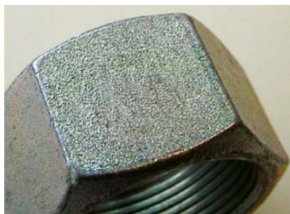
Рис. 3. Оцинкованная гайка с шероховатой поверхностью
