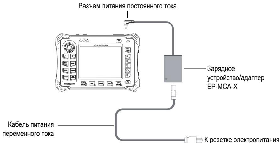
**Рис. 1-8 Подключение зарядного устройства/адаптера**
