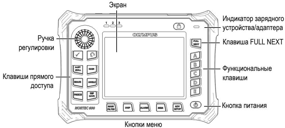
Рис. 1-16 Передняя панель с клавиатурой и ручкой регулировки
