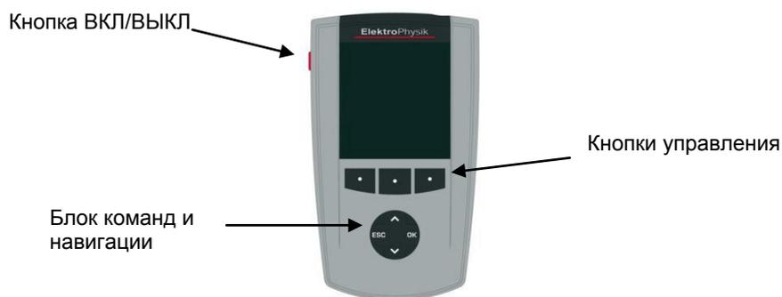
Используйте кнопку Вкл/Выкл для включения или выключения прибора. Если Вы нажмете одновременно кнопку Вкл/Выкл и ESC, начнется процедура инициализации (см. раздел. 11.1)
