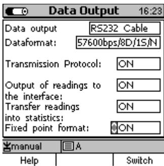
Настройка "Fixed point format" (формат фиксированной точки) определяет формат данных, передаваемых через интерфейс RS232
