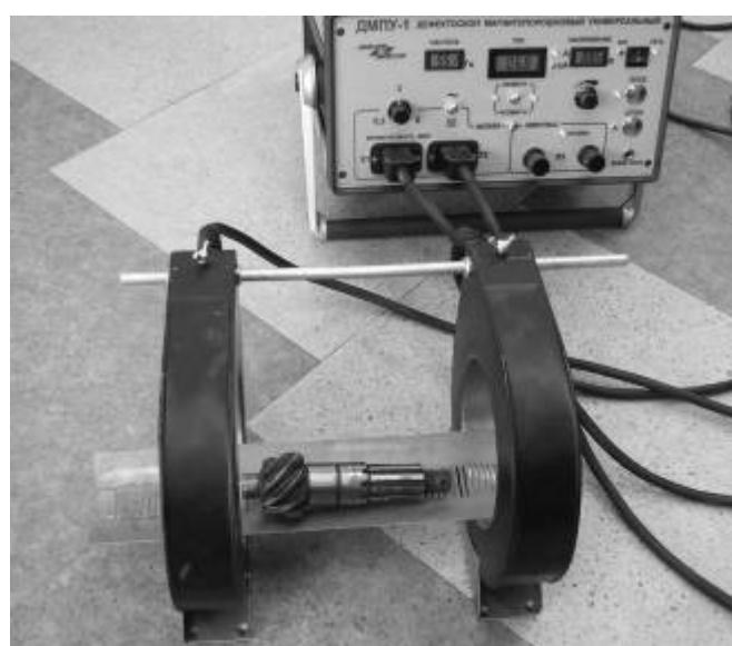
Рисунок 2 – Катушки намагничивания
