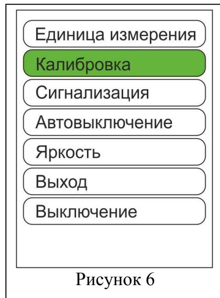
6.6 Кнопкой «ВНИЗ» установить подсвеченный маркер на пункт «КАЛИБРОВКА» и нажать кнопку «ОК». Выбрать из появившемся на дисплее окна пункт «УСТАНОВКА 0» и нажать кнопку «ОК» .
