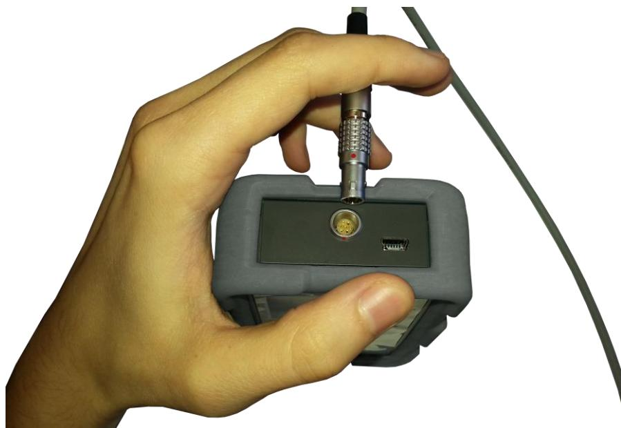
Рисунок 2.2 – Подключение преобразователя
