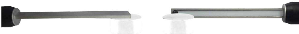
Рисунок 2.14 – Измерение нормальной составляющей вектора индукции постоянного магнитного поля на торцевой и боковой поверхности изделия
