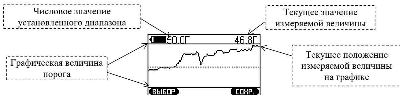
Рисунок 2.11 – Работа прибора в графическом режиме
