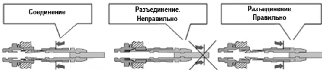
Рисунок 2.4 – Манипулирование разъемами
