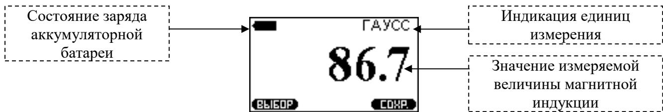
Рисунок 2.7 – Отображение информации во время работы прибора
