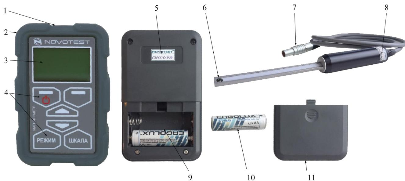
1 – разъем для подключения преобразователя; 2 – защитный силиконовый чехол;
