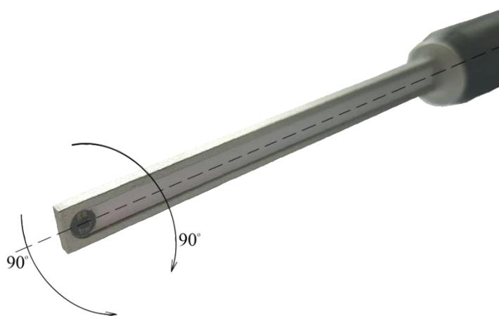
Рисунок 2.13 – Переворот преобразователя на  $90^{\circ}$  относительно своей оси
