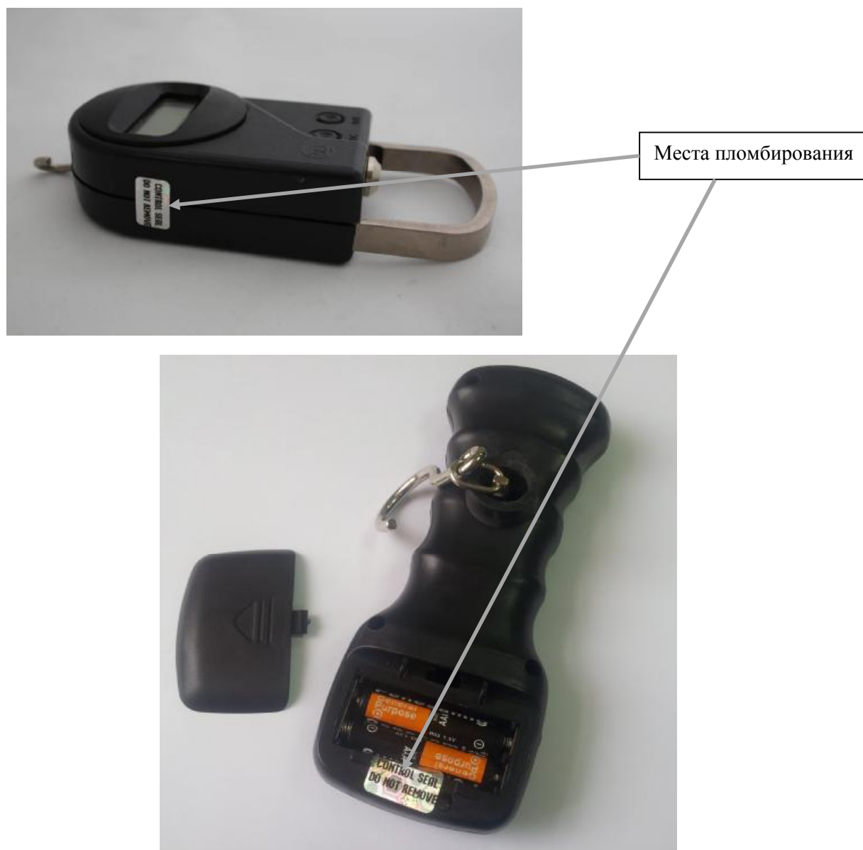
Рисунок 3 - Схема пломбирования электронного блока от несанкционированного доступа
