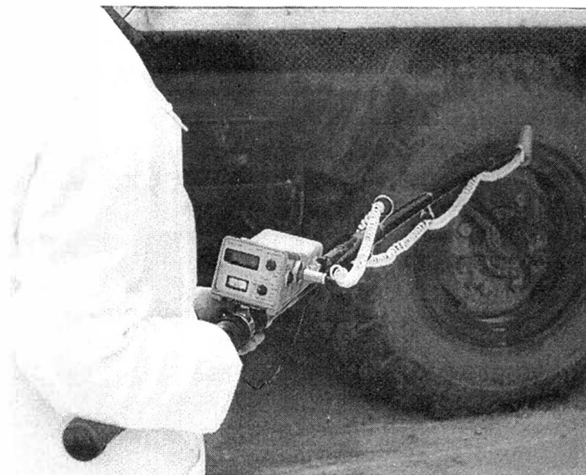
Вариант ДКС-96М (с газоразрядными счетчиками). Используется для радиационного обследования и обнаружения источников в удаленных и труднодоступных местах (до 4-5 метров).
