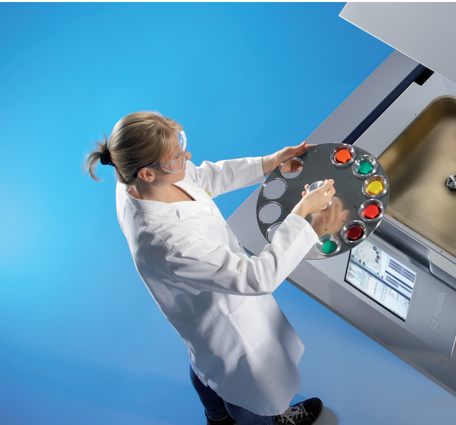
Быстрая загрузка целых партий или крупных образцов в S2 PUMA при помощи карусельного загрузчика EasyLoad
