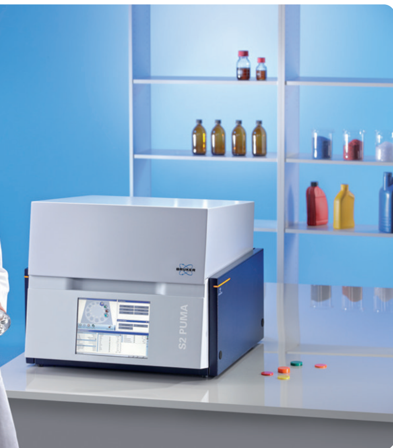
Быстрая загрузка целых партий при помощи карусельного загрузчика S2 PUMA EasyLoad
