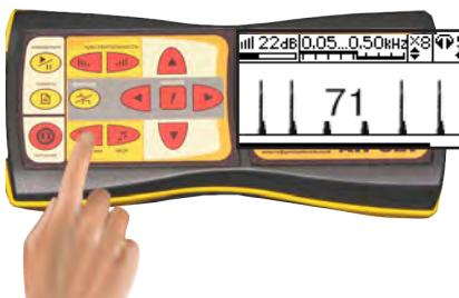
10. наблюдать на индикаторе импульсные сигналы от ударного механизма с частотой, соответствующей частоте следования ударных импульсов, установленной на генераторе (0,5/1,0/2,0 Гц)
