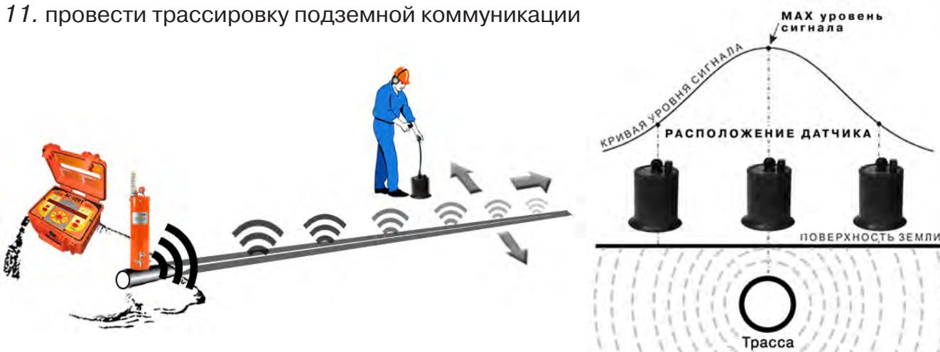
Продвигаясь вдоль трассы, следует переставлять акустический датчик поперек трассы в одну и другую сторону для определения точки с максимальным уровнем сигнала. Место с максимальным уровнем искомого сигнала будет располагаться над предполагаемой осью коммуникации.
