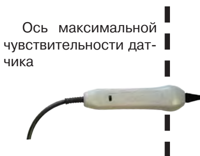
Выбор кабеля по максимальному сигналу
