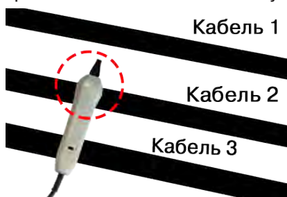
Выбор кабеля по максимальному сигналу
