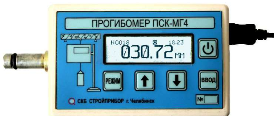
Рисунок 1.2 – Вид электронного блока прогибомера.
