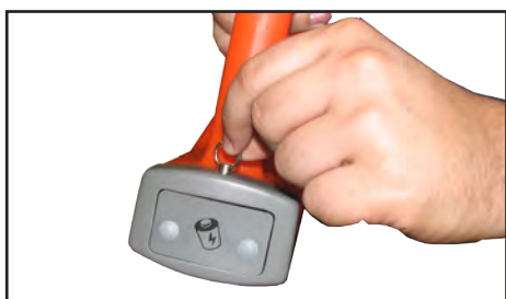
а) Выдвинуть фиксатор и освободить батарейный отсек
