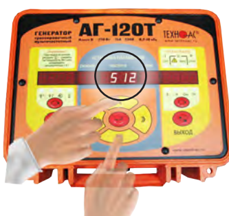
6. Установить частоту генерации (512/1024/8192 Гц)
