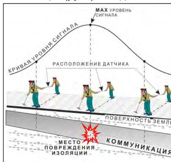
применение датчика-определителя дефектов коммуникации (ДОДК) методом max
