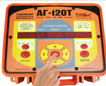
3. Нажать кнопку «Ввод» для входа в «установку параметров»
