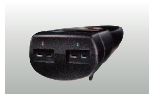
2 разъема для подсоединения зондов
