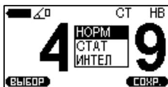
Рисунок 2.11 – Выбор режима измерений
