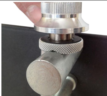
Рисунок 1.5 – Измерение твердости на цилиндрических поверхностях
