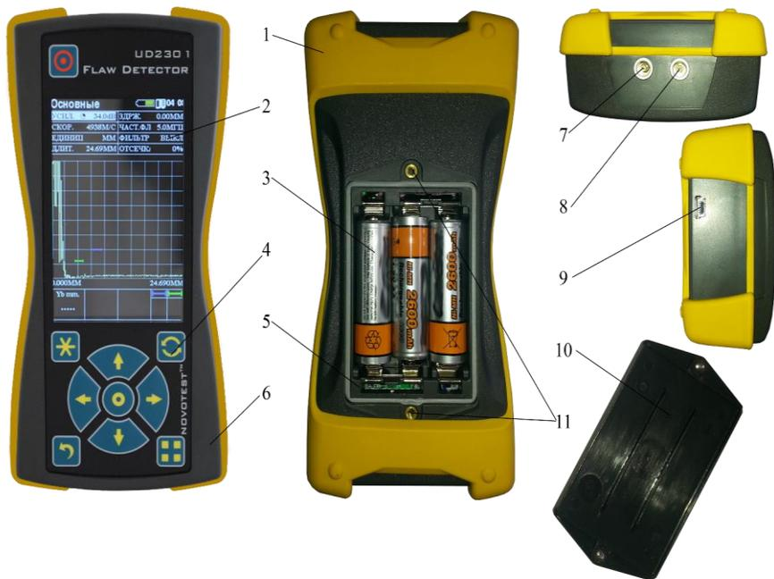
1 – защитный чехол; 2 – контрастный цветной LCD/TFT дисплей; 3 – аккумулятор типа NiMH; 4 – клавиатура управления; 5 – отсек для батарей; 6 – электронный блок; 7 – разъем для совмещенного преобразователя и передающего пьезоэлемента; 8 – разъем для приемного пьезоэлемента; 9 – разъем miniUSB; 10 – крышка; 11 – резьбовое соединение для закрепления крышки.
