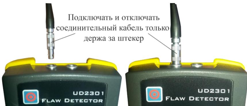
Рисунок 2.5 – Подключение совмещенного преобразователя к прибору
