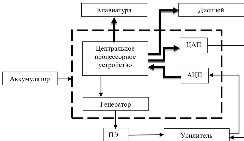
Конструктивно дефектоскоп состоит из индикаторной панели, центральной платы, аналоговой платы, платы процессора, памяти и аккумуляторной батареи.
