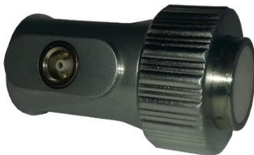
Рисунок 1.4 – Внешний вид прямого совмещенного преобразователя
