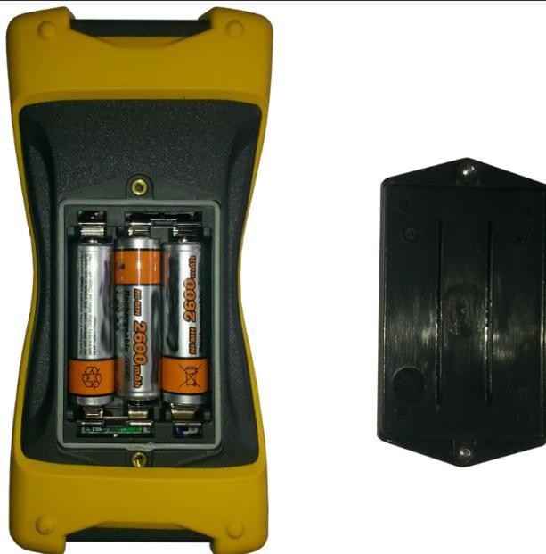
Рисунок 2.1 – Установка элементов питания
