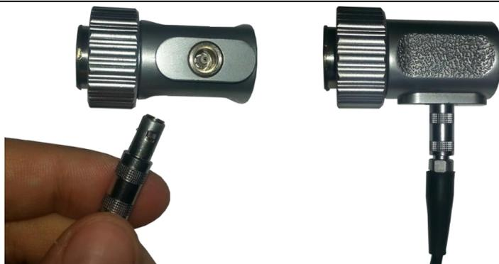
Рисунок 2.4 – Подключение совмещенного преобразователя к кабелю
